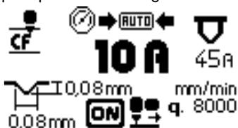
O gerador exibe automaticamente a largura e a profundidade do sulco que pode ser obtido com os valores de corrente (Fig. 4 Ref. G) e velocidade de trabalho relativa (Fig. 4 Ref. E) definidos pelo operador e indica o bico a usar (Fig. 4 Ref. F).
