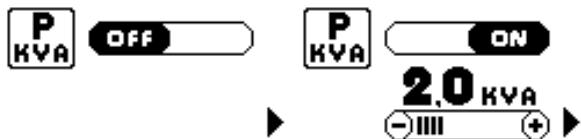
Der werkseitige Standardmodus ist OFF, was bedeutet, dass keinerlei Begrenzung der Stromaufnahme am Eingang vorliegt. Falls es jedoch notwendig ist, kann diese Funktion auf ON geschaltet werden, dann wird der Wert für die maximale Stromaufnahme gewählt, um den Generator an die Anlage anzupassen, mit der er verbunden wird. Auf diese Art kann er problemlos an alle Industrieanlagen angeschlossen werden, und Überlast und die entsprechenden Auslösungen der Schutzvorrichtungen werden vermieden.
