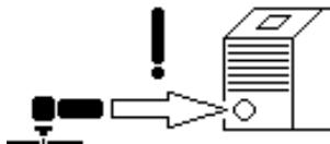
Si aparece esta imagen, la máquina indica que no se ha conectado ninguna antorcha o que no se ha insertado correctamente o se ha conectado una antorcha no válida. Para restablecer el correcto funcionamiento, apagar la máquina, volver a introducir la antorcha como se indica en el párrafo 1.1 y encender de nuevo la máquina.
