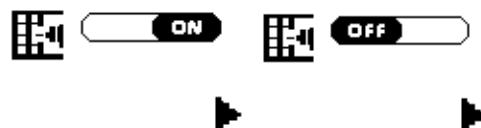
Lorsque la fonction est activée, à la fin de découpe, tout en gardant le bouton enfoncé, l'arc pilote se rallumera automatiquement.
