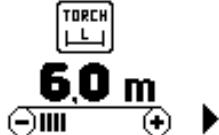
Um das Menü zu verlassen, ohne eine Wahl getätigkt zu haben, einfach den Cursor auf dem Pfeil unten rechts platzieren und den Knauf S1 (Abb. 1) drücken, um das Verlassen zu bestätigen.
