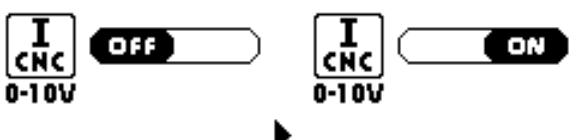
La modalità default di fabbrica è OFF il che comporta che non via sia alcuna possibilità di regolazione della corrente di taglio da remoto tra il pin 1 (0V) e il pin 2 (10V).
