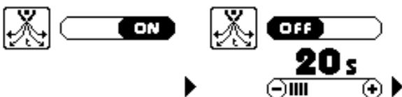
La modalità default di fabbrica è AUTO ON che permette al generatore di regolare automaticamente e sinergicamente la durata del post gas in funzione della torcia inserita, del valore di corrente impostato e del processo di lavorazione selezionato. E' comunque possibile impostare questa funzione in OFF, in modo da poter regolare manualmente la durata del post gas (entro certi limiti preimpostati).
