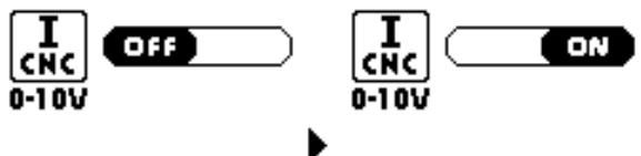
A modalidade padrão de fábrica é OFF [Desligado] o que implica que não haja qualquer possibilidade de regulação da corrente de corte remotamente entre o pino 1 (0V) e o pino 2 (10V).
