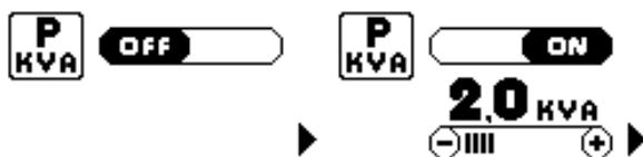
La modalité par défaut d'usine est OFF ce qui comporte qu'il n'y a aucune limitation de la puissance absorbée à l'entrée. Cependant si nécessaire en positionnant sur ON cette fonction, on peut sélectionner la valeur de puissance maximale absorbée pour adapter le générateur à l'équipement auquel il sera connecté. De cette manière il sera possible de le connecter facilement à tous les équipements industriels en évitant des surcharges ou l'intervention des protections correspondantes.
