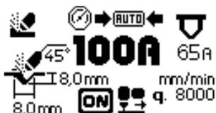
O gerador exibe automaticamente a largura e a profundidade do sulco que pode ser obtido com os valores de corrente (Fig. 4 Ref. G) à velocidade de trabalho relativa (Fig. 4 Ref. E) definidos pelo utilizador e indica o bico a utilizar (Fig. 4 Ref. F) e a inclinação em graus à qual deve ser mantida a tocha durante o avanço.
