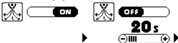
La modalité par défaut d'usine est AUTO ON qui permet au générateur de régler automatiquement et de manière synergique la durée du post gaz par rapport à la torche insérée, de la valeur de courant configurée et du processus d'usinage sélectionné. Il est de toute manière possible de configurer cette fonction en OFF, de manière à pouvoir régler manuellement la durée du post gaz (dans certaines limites fixées).
