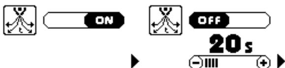
A modalidade padrão de fábrica é AUTO ON [AUTOMATICAMENTE LIGADO] que permite ao gerador de regular automaticamente e sinergicamente a duração do pós-gás em função da tocha inserida, do valor de corrente definido e do processo de trabalho selecionado. De qualquer modo é possível configurar esta função em OFF [Desligado] de modo a poder regular manualmente a duração do pós-gás (dentro de certos limites predefinidos).
