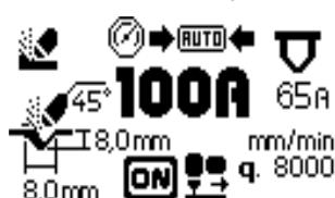
Der Generator zeigt automatisch die Breite und die Tiefe der mit den Stromwerten erzielbaren Rille (Abb. 4 Bez. G) bei entsprechender Betriebsgeschwindigkeit (Abb. 4 Bez. E) an, die vom Bediener eingestellt wurden und gibt auch die zu verwendende Düse (Abb. 4 Bez. F) und die Neigung in Grad an, mit der der Schneidbrenner während des Vorschubs gehalten werden muss.
