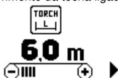
Para sair do menu sem realizar qualquer seleção, posicionar o cursor na seta em baixo à direita e pressionar o manípulo S1 (Fig.1) para confirmar a saída.
