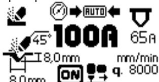
El generador mostrará automáticamente la anchura y la profundidad del surco que se obtiene con los valores de corriente (Fig. 4 Ref. G) a la velocidad de elaboración relativa (Fig. 4 Ref. E) configuradas por el operador e indicará la boquilla que hay que utilizar (Fig.4 Ref.F) y la inclinación en grados a la que debe mantenerse la antorcha durante el avance.
