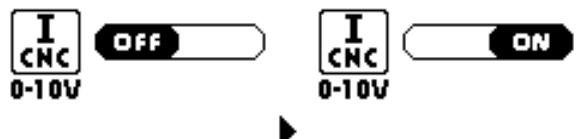
La modalité par défaut d'usine est OFF avec comme conséquence l'impossibilité de régler le courant de découpe à distance entre le pin 1 (0V) et le pin 2 (10V).
