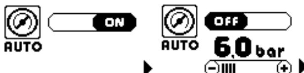
La modalità default di fabbrica è AUTO ON che permette al generatore di mantenere costante e al valore ottimale la pressione di lavoro della torcia, anche in presenza di variazioni della pressione di ingresso. Questo sistema impostato in modalità automatica consente infatti di non eseguire alcuna regolazione della pressione, sarà il generatore ad impostare il valore corretto in funzione della torcia inserita e della lavorazione selezionata.
