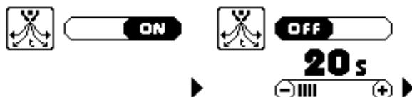
La modalidad por defecto de fábrica es AUTO ON, que permite que el generador regule automáticamente y sinérgicamente la duración del post gas en función de la antorcha activada, del valor de corriente configurado y del proceso de elaboración seleccionado. De todas formas, esta función puede configurarse en OFF para poder regular manualmente la duración del post gas (dentro de ciertos límites preconfigurados).
