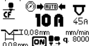
El generador mostrará automáticamente la anchura y la profundidad del surco que se obtiene con los valores de corriente (Fig. 4 Ref. G) y la velocidad de elaboración relativa (Fig. 4 Ref. E) configuradas por el operador e indicará la boquilla que hay que utilizar (Fig.4 Ref.F).
