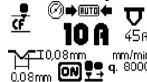
Der Generator zeigt automatisch die Breite und die Tiefe der mit den Stromwerten erzielbaren Rille (Abb. 4 Bez. G) und die entsprechende Betriebsgeschwindigkeit (Abb. 4 Bez. E) an, die vom Bediener eingestellt wurde, und es wird auch die zu verwendende Düse angegeben (Abb. 4 Bez. F).
